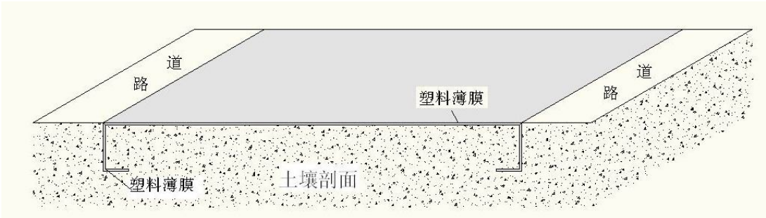
图1 土壤反埋法示意图
